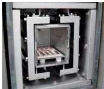
Тепловая обработка медных стержней в водороде в печи VNT 08/16 MO
