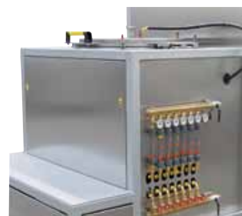
Система регулирования водяного охлаждения
