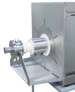
Газонепроницаемое исполнение с фланцами с водяным охлаждением
