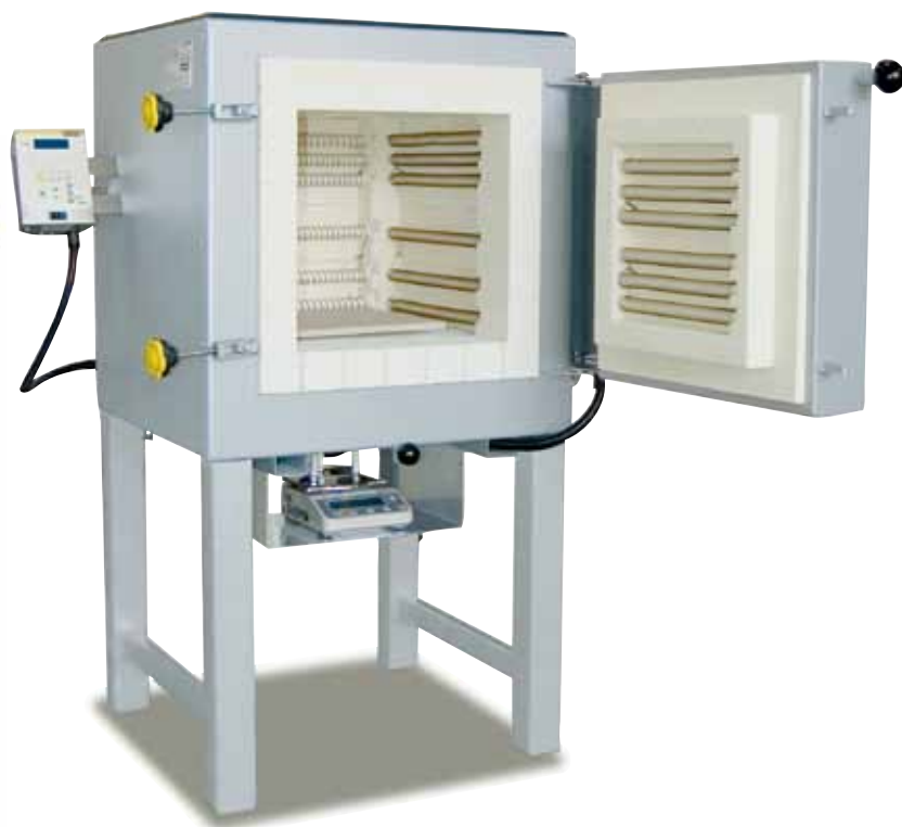
ЛН 60/12 со взвешивающим устройством для определения потерь при прокаливании
