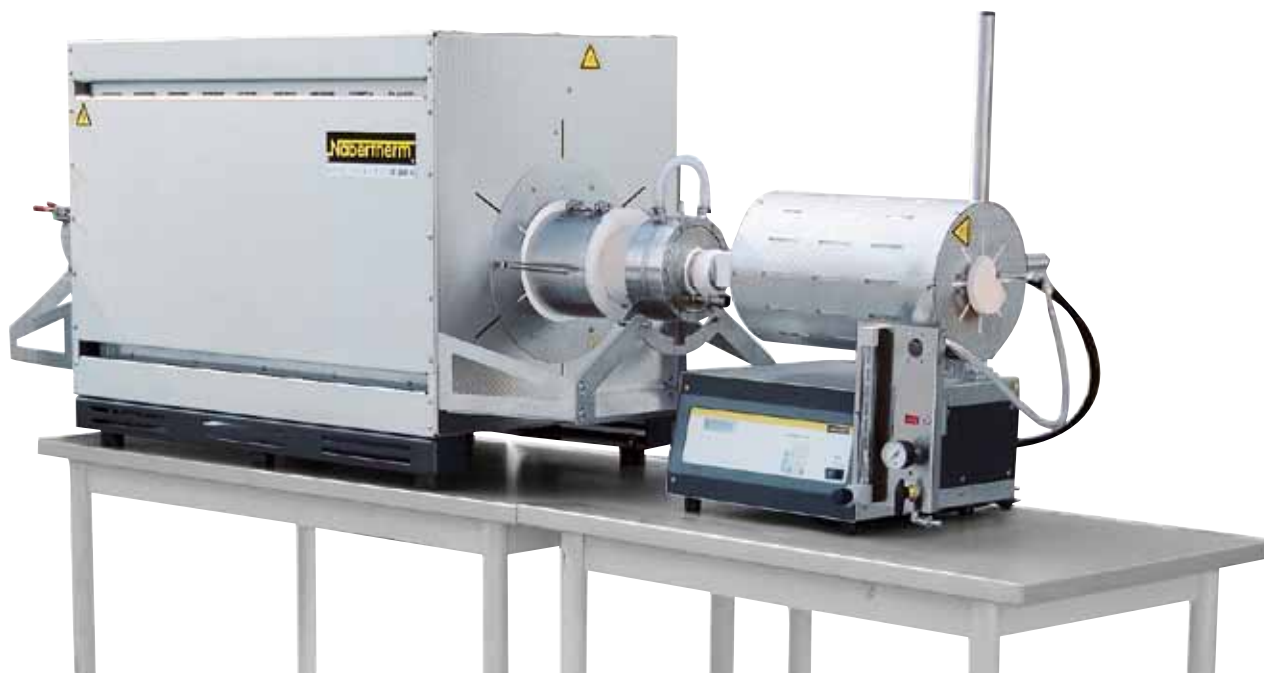
RHTH 120/600/16 с предвключенной печью RT 50-250/11 для предварительного подогрева технологического газа
