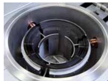
Цилиндрическая реторта с вольфрамовым нагревом
